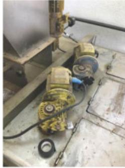
36.-Proteger tornillo de la máquina del polielectrolito, para evitar atrapamientos. Colocar señalización relativa al riesgo de atrapamiento. RIESGO MODERADO.
